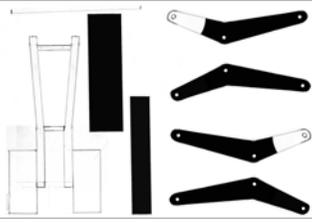
Befestigungsösen zu "rechtwinkeligem U" biegen und an den Zylinderenden anbringen
