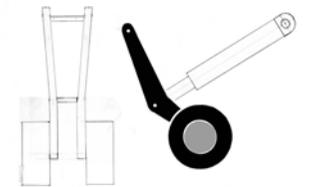
Fahrwerksbein und Hydraulikzylinder erst bei endgültigem Einbau miteinander verkleben.
